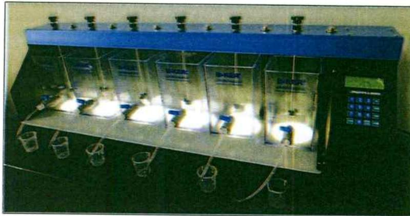
Figura 8. Ensayo de Jarras
