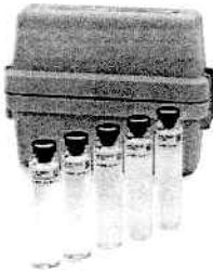
Figura 12. StablCal de 20, 100 y 800 NTU.
