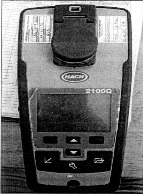
Nota: Turbidímetro 2100Q de marca HACH
